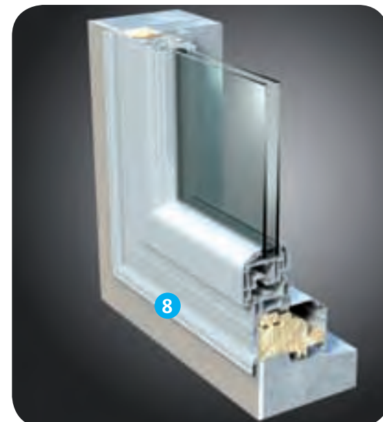
Angle menuiserie PVC équipée d'un plat PVC mouluré (profil X7767) permettant un recouvrement totale de 100 mm.
